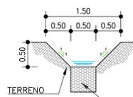
SEZIONE TIPO POSIZIONAMENTO FOSSI DI GUARDIA TIPO "A" E "B"
