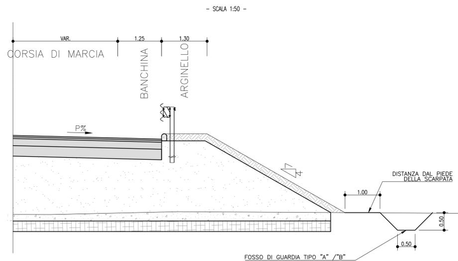
SEZIONE TIPO SU RILEVATO
