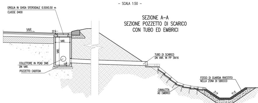
SEZIONE TIPO POSIZIONAMENTO FOSSI DI GUARDIA TIPO "A" E "B"
