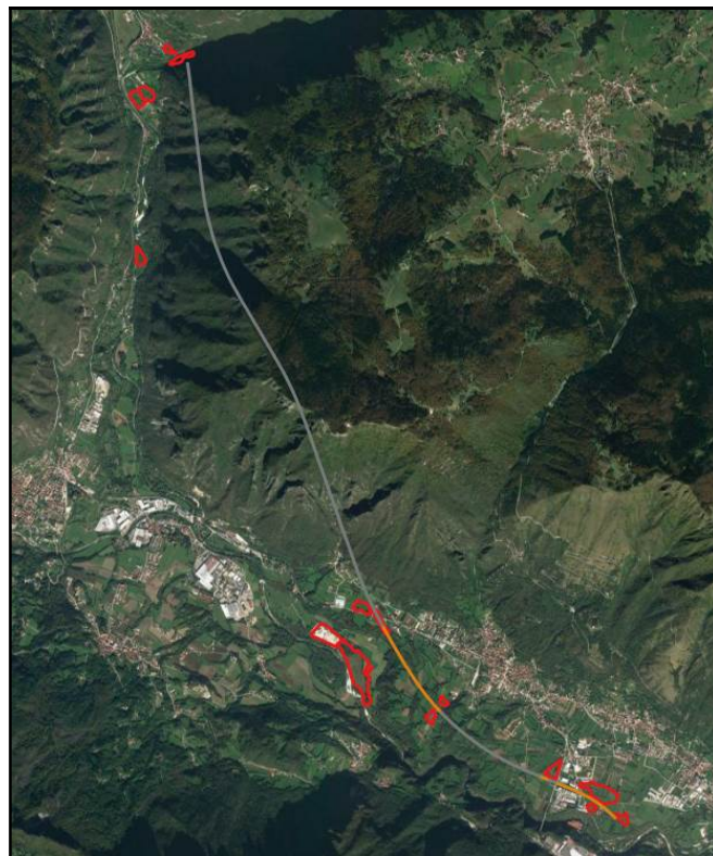
Figura 29: Localizzazione delle aree di cantiere lungo il tracciato fino a Val d’Assa. I tratti in galleria sono di colore grigio, mentre i tratti in superficie (interferenza diretta con la componente in esame) sono in arancione
