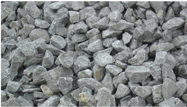
Figura 93 Roccia derivante da processi di vagliatura di materiali inerti di origine dolomica
