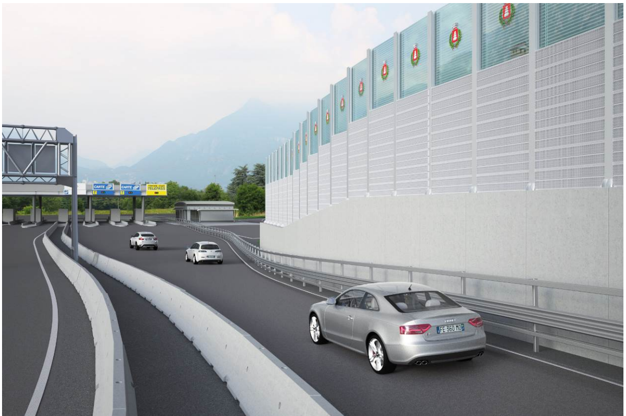
Figura 75: Barriera antirumore in plastica riciclata e PMMA, con colori e stemma del Comune di Cogollo del Cengio
