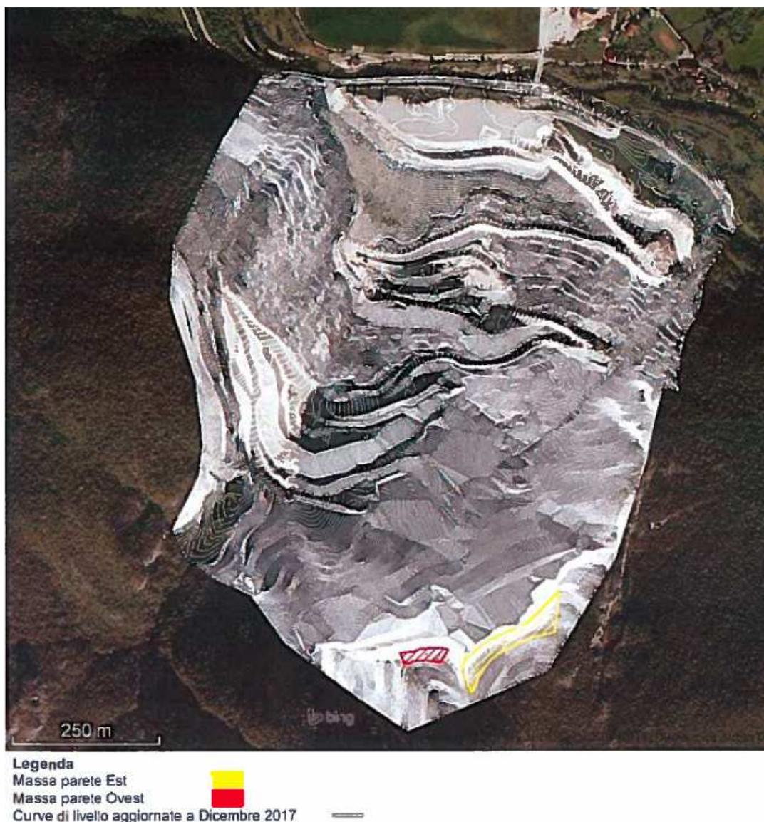
Figura 45 – Localizzazione delle masse instabili utilizzate per le simulazioni numeriche
