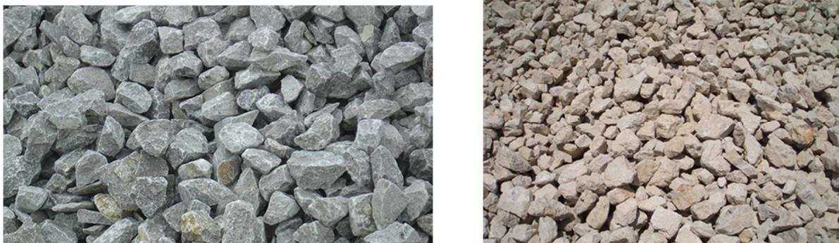
Figura 2 Roccia derivante da processi di vagliatura di materiali inerti di origine dolomica
