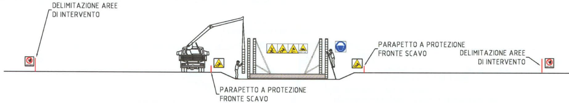
**NB:** L'ACCESSO ALL'AREA DI MOVIMENTAZIONE DELLE CASSAFORME DEVE ESSERE CONSENTITO SOLO AL PERSONALE SPECIFICO - MASSIMA ATTENZIONE ALLE FASI DI MOVIMENTAZIONE DELLE CASSAFORME
