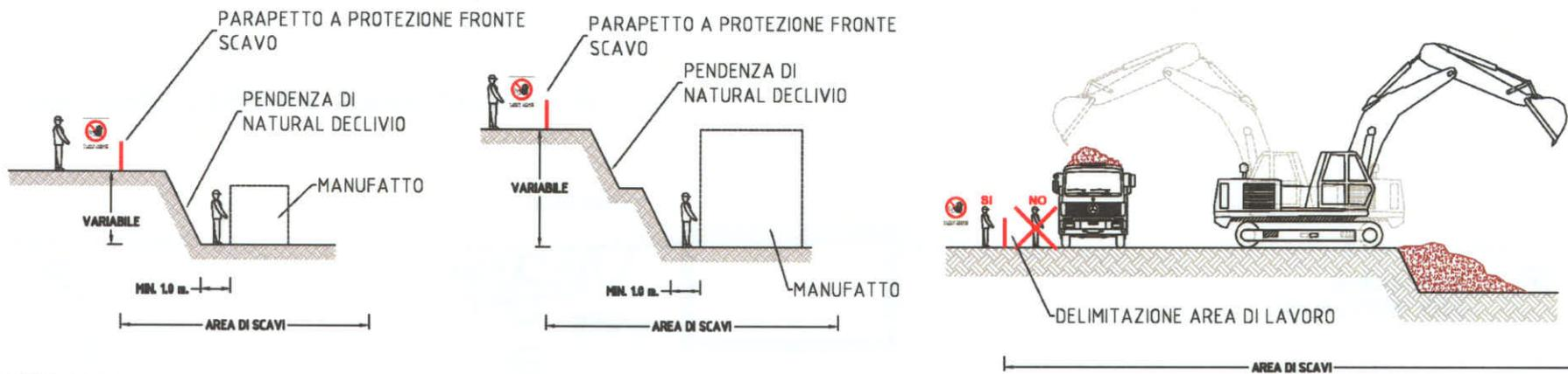
**NB:** FRONTE DI SCAVO CON ANGOLO DI NATURAL DECLIVIO. CONSULTARE RELAZIONE GEOLOGICA. PER SCAVI OVE NON SIA POSSIBILE MANTENERE IL NATURAL DECLIVIO PREVEDERE OPERE DI PROTEZIONE DEI FRONTI. PREDISPORRE RAMPE DI ACCESSO A FONDO SCAVO. PREVEDERE PARAPETTI DI PROTEZIONE LUNGO LE RAMPE
