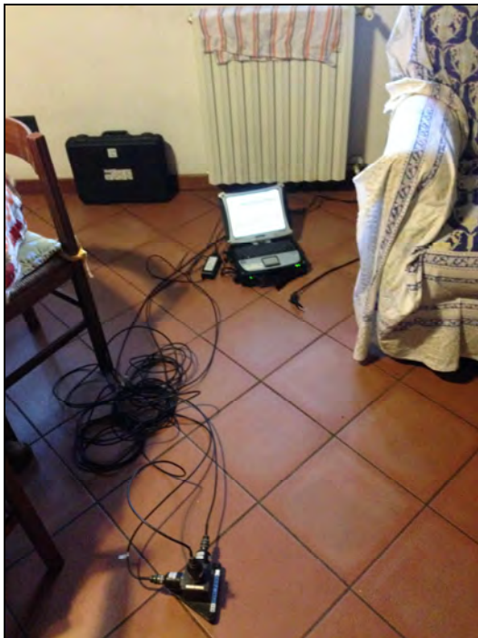
Posizionamento terna accelerometrica, 1° piano f.t.
