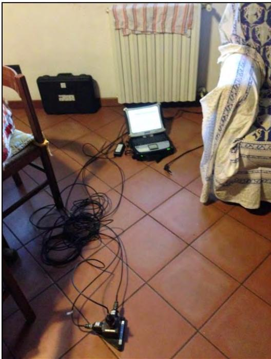
*Posizionamento terna accelerometrica, 1° piano f.t.*
