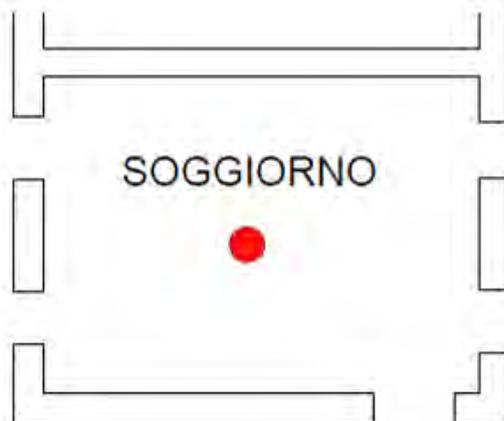
*Posizionamento terna accelerometrica, 1° piano f.t.*
