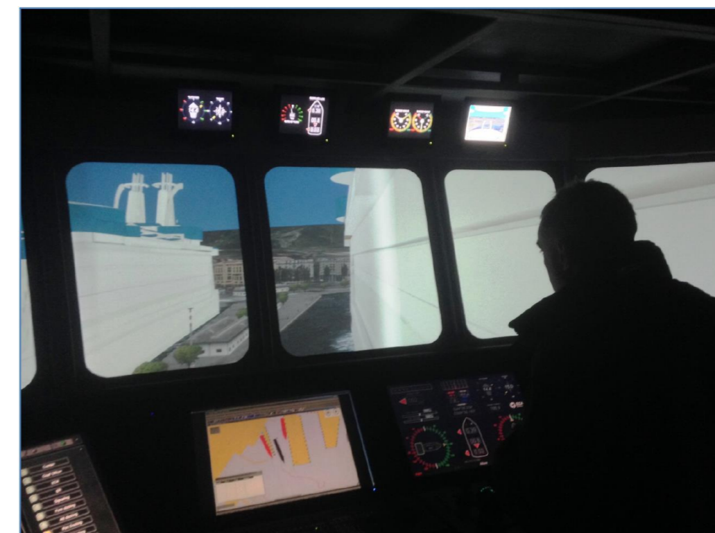
FIGURA 3-7 CONSOLLE DI PLANCIA: SIMULATORE DELLE MANOVRE
