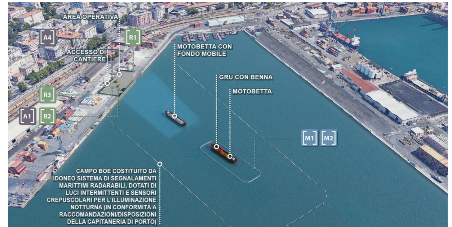
FIGURA 3-28 – SIMULAZIONE FOTOREALISTICA DELL'AREA OPERATIVA A MARE DURANTE LE FASI DI SCAVO (ESTRATTO DALL'ELAB. SPA.07.06)
