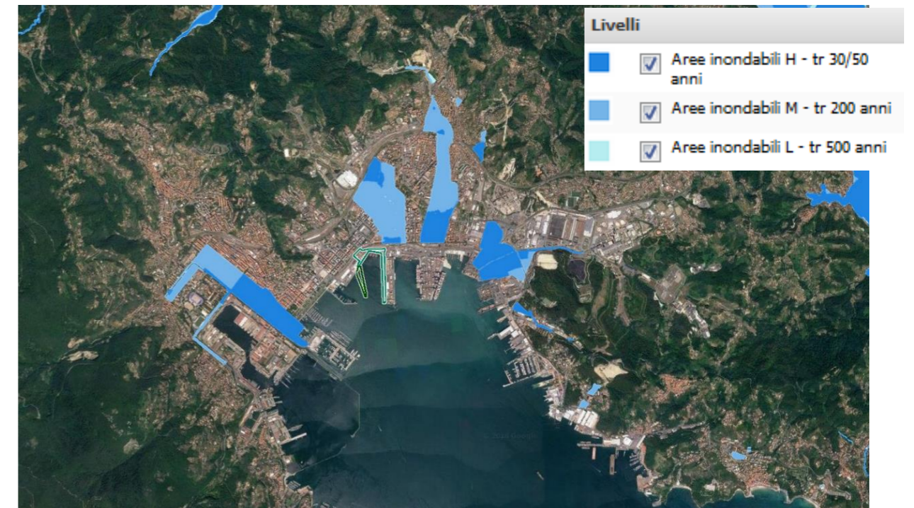
FIGURA 2-6: PERICOLOSITÀ DA ALLUVIONE FLUVIALE (FONTE: PGRA REGIONE LIGURIA – GEOPORTALE CARTOGRAFICO) ED IN VERDE IL LIMITE DEL NUOVO MOLO CROCIERE E DELL'AMBITO DI RIQUALIFICAZIONE AD ESSO AFERENTE
