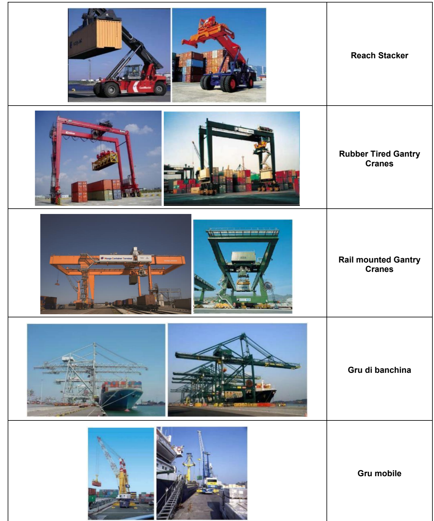
Figura 4-95 - Alcuni mezzi impiegati per la movimentazione dei container
