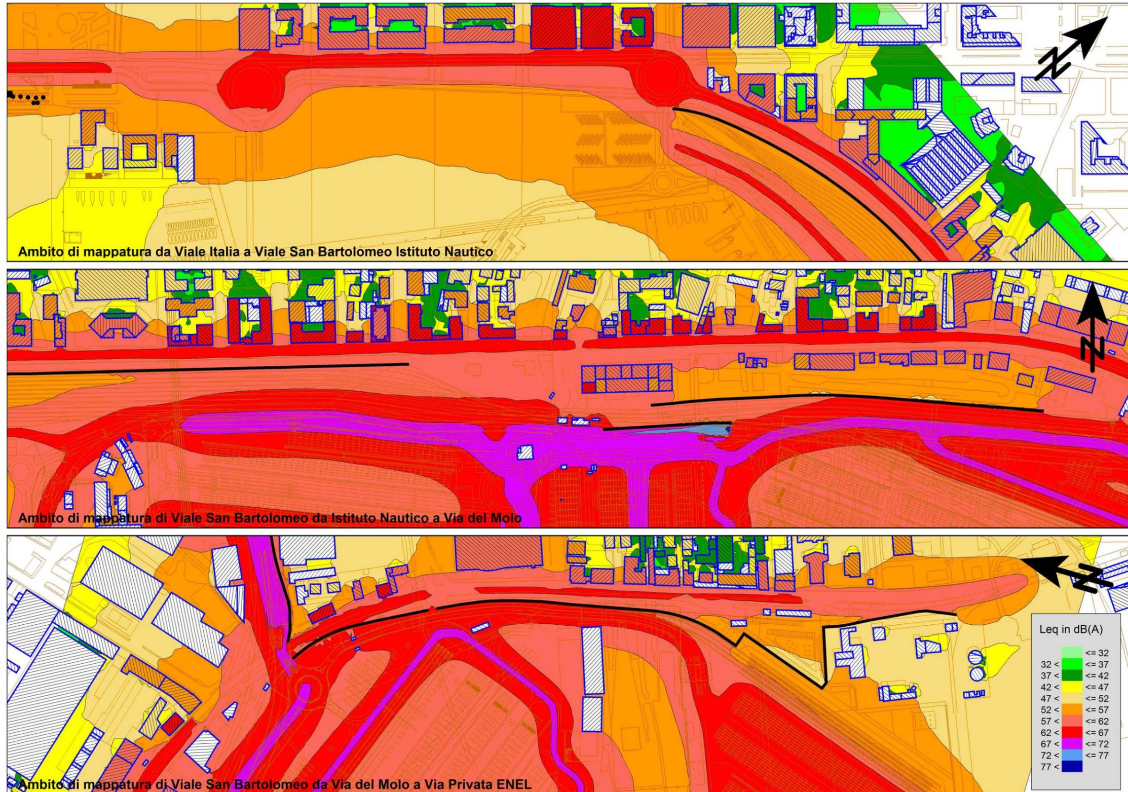
FIGURA 5-23 – MAPPATURA DEI LIVELLI DI RUMORE DI ORIGINE STRADALE – STATO DI PROGETTO – PERIODO DI RIFERIMENTO NOTTURNO (SCALA 32-77 DBA)
