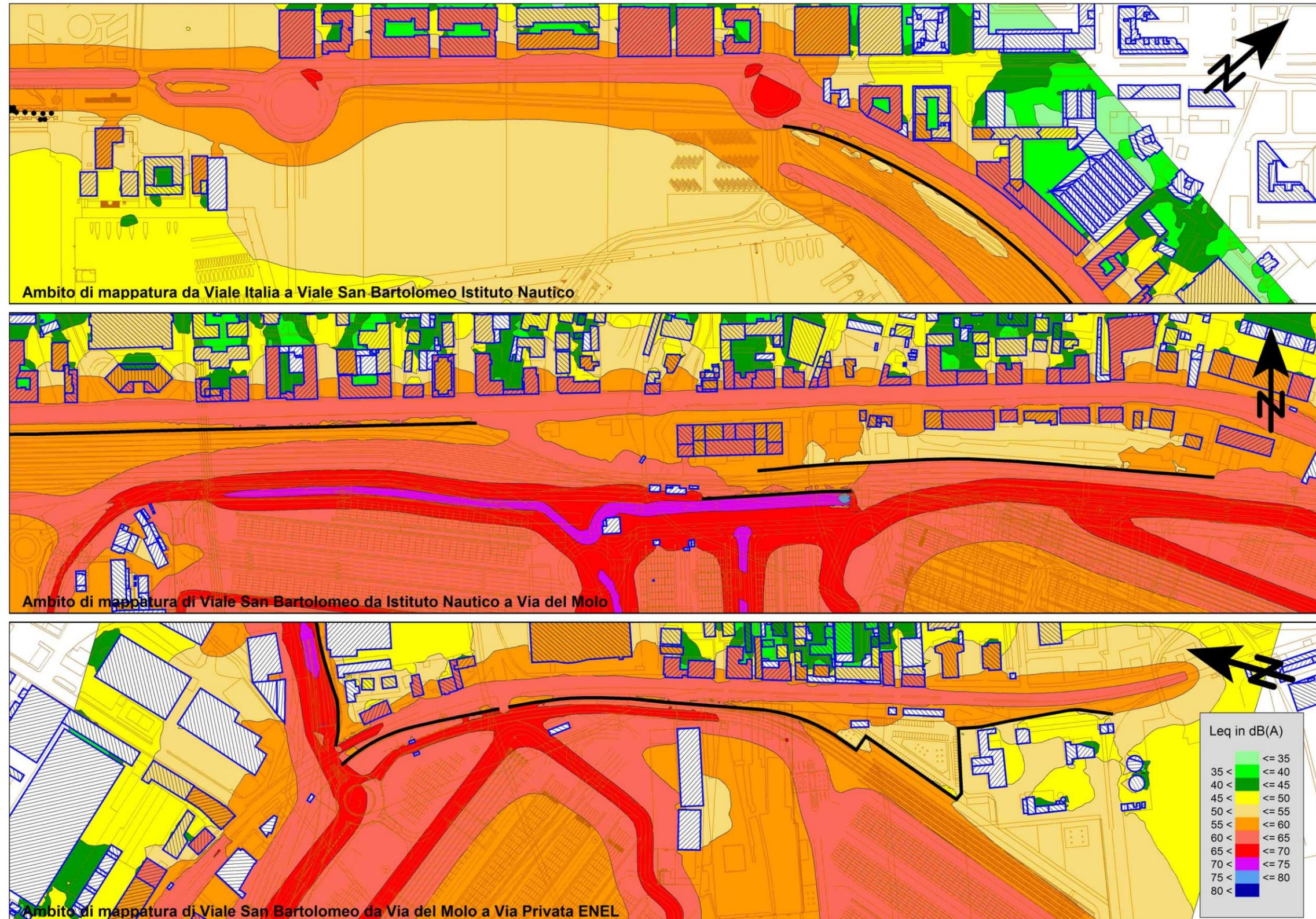
FIGURA 5-21 – MAPPATURA DEI LIVELLI DI RUMORE DI ORIGINE STRADALE – STATO DI PROGETTO – PERIODO DI RIFERIMENTO NOTTURNO (SCALA 35-80 DBA)
