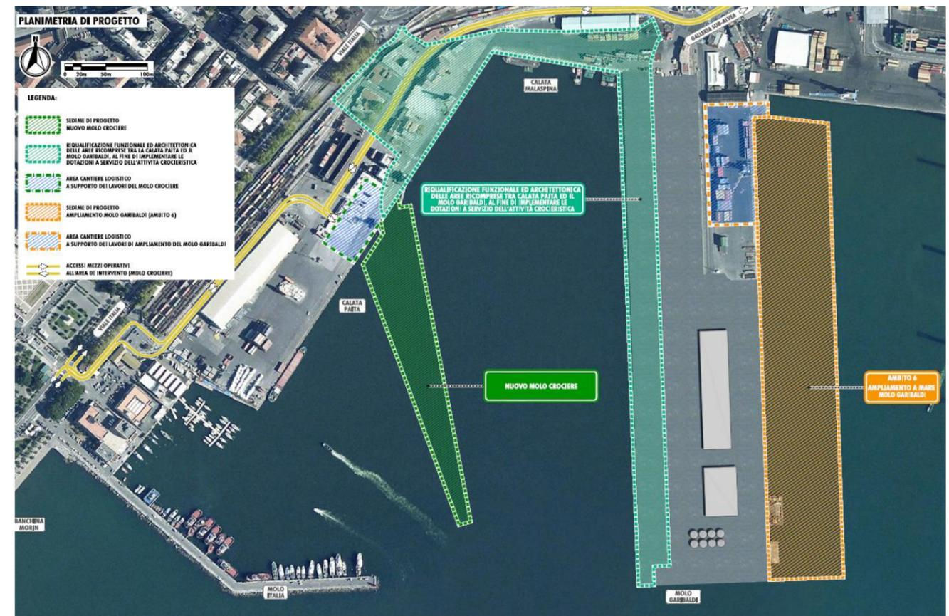
FIGURA 4-16 – PLANIMETRIA DELL'AMBITO DI CANTIERE PER LA REALIZZAZIONE DEL NUOVO MOLO CROCIERE, RAPPORATO ALL'AMBITO DI CANTIERE AFFERENTE ALL'AMPLIAMENTO A MARE DEL "MOLO GARIBALDI" (AMBITO 6) (ESTRATTO DALL'ELAB. SPA.06)
