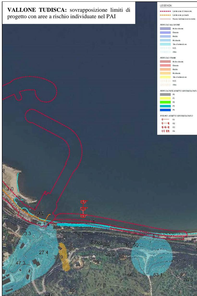
L'intervento proposto, in accordo con le indicazioni del PAI, basa i suoi presupposti sia migliorando le condizioni di deflusso alla foce con la rigeometrizzazione della stessa, la riprofilatura dell'alveo e la sua stabilizzazione sia intervenendo sulla scogliera esistente con un intervento di rifioritura per mitigare il rischio da arretramento della linea di costa.
