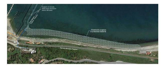
Analoga scelta è stata fatta lato Ovest per mitigare il rischio R2 previsto nel PAI. Come detto in precedenza, oggi esiste un muro di protezione di altezza variabile che è stato nel passato eretto a difesa del rilevato ferroviario che qui si avvicina molto alla linea di battigia.
