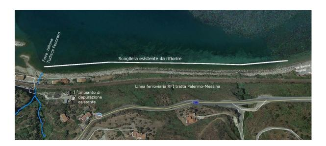
Lato Ovest invece le opere di difesa sono oggi costituite da muri sulla spiaggia a protezione delle opere ferroviarie.
