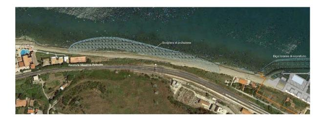
Inoltre per continuare a garantire il flusso di materiale tra Ovest ed Est del porto è prevista l'installazione di un impianto di by-pass con cui i materiali intercettati dalla diga foranea di sopraflutto vengono periodicamente riportati in circolo lato Messina al fine di garantire le attuali condizioni di trasporto solido.
