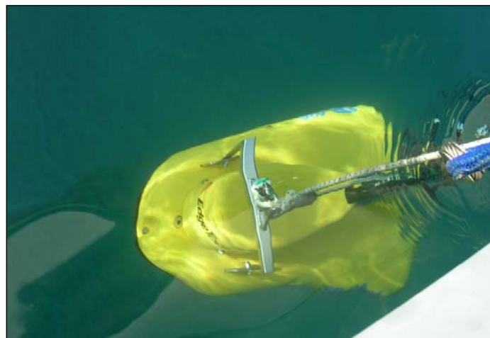
Fig. 5 - Installazione trasduttore S.B.P. a lato imbarcazione
