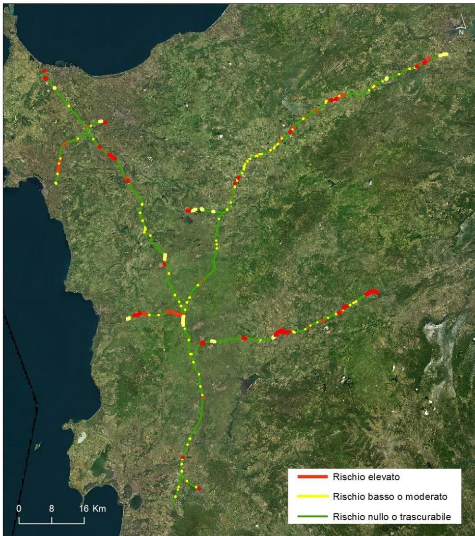
**Fig. 4/A: Carta del rischio di contaminazione del suolo e sottosuolo lungo i tracciati dei metanodotti.**
