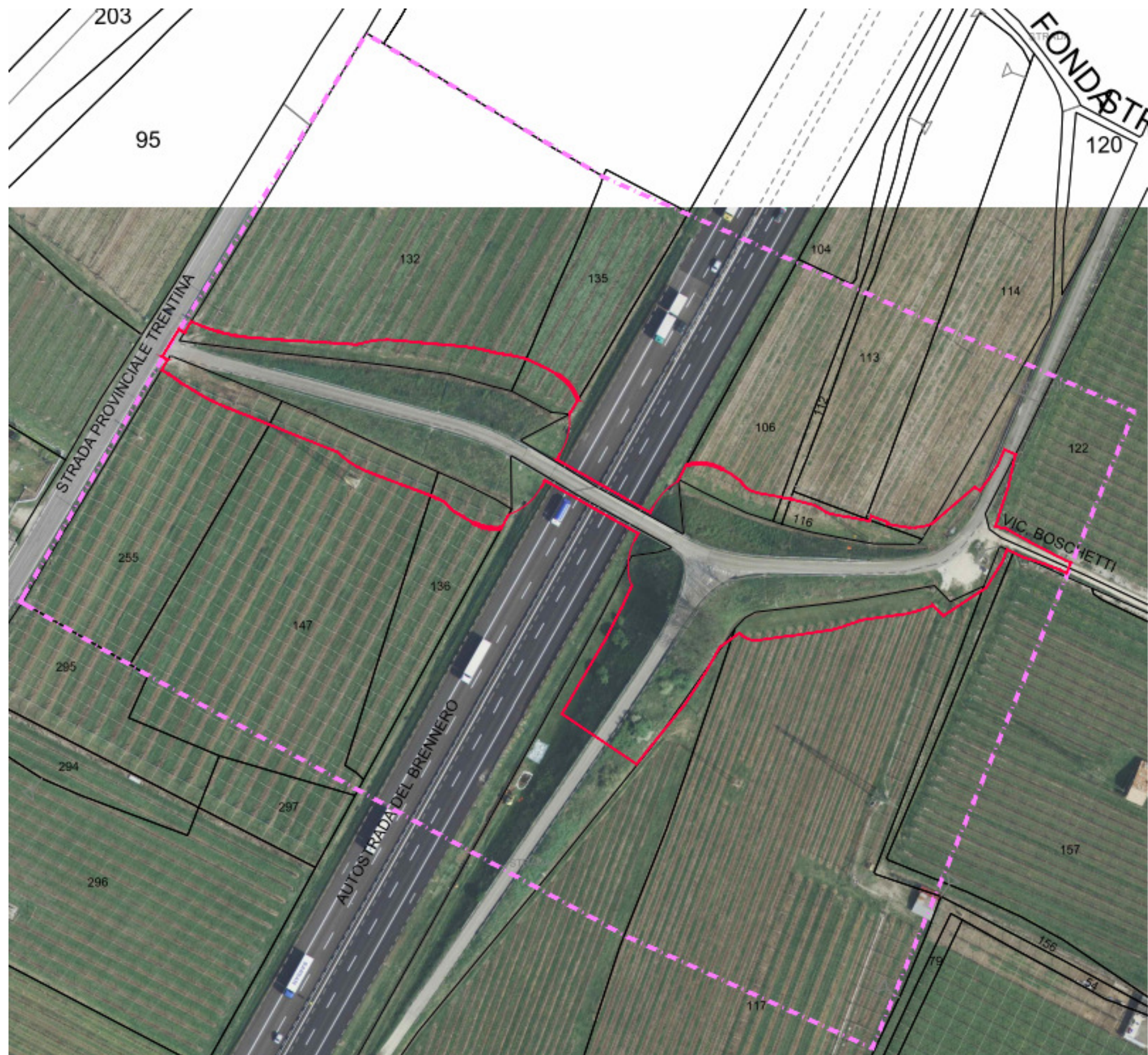
TAVOLA 5 - Stralcio Tav. 13.2.4 di progetto, con indicato il limite dell'area di intervento (linea rossa) e il perimetro all'interno del quale saranno ubicate le aree logistiche e di deposito (linea tratteggiata rosa)
