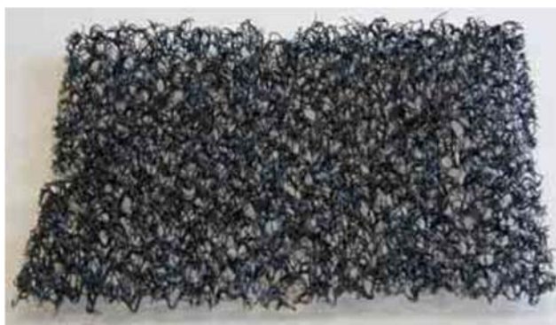
Esempio di struttura di geostuoia
