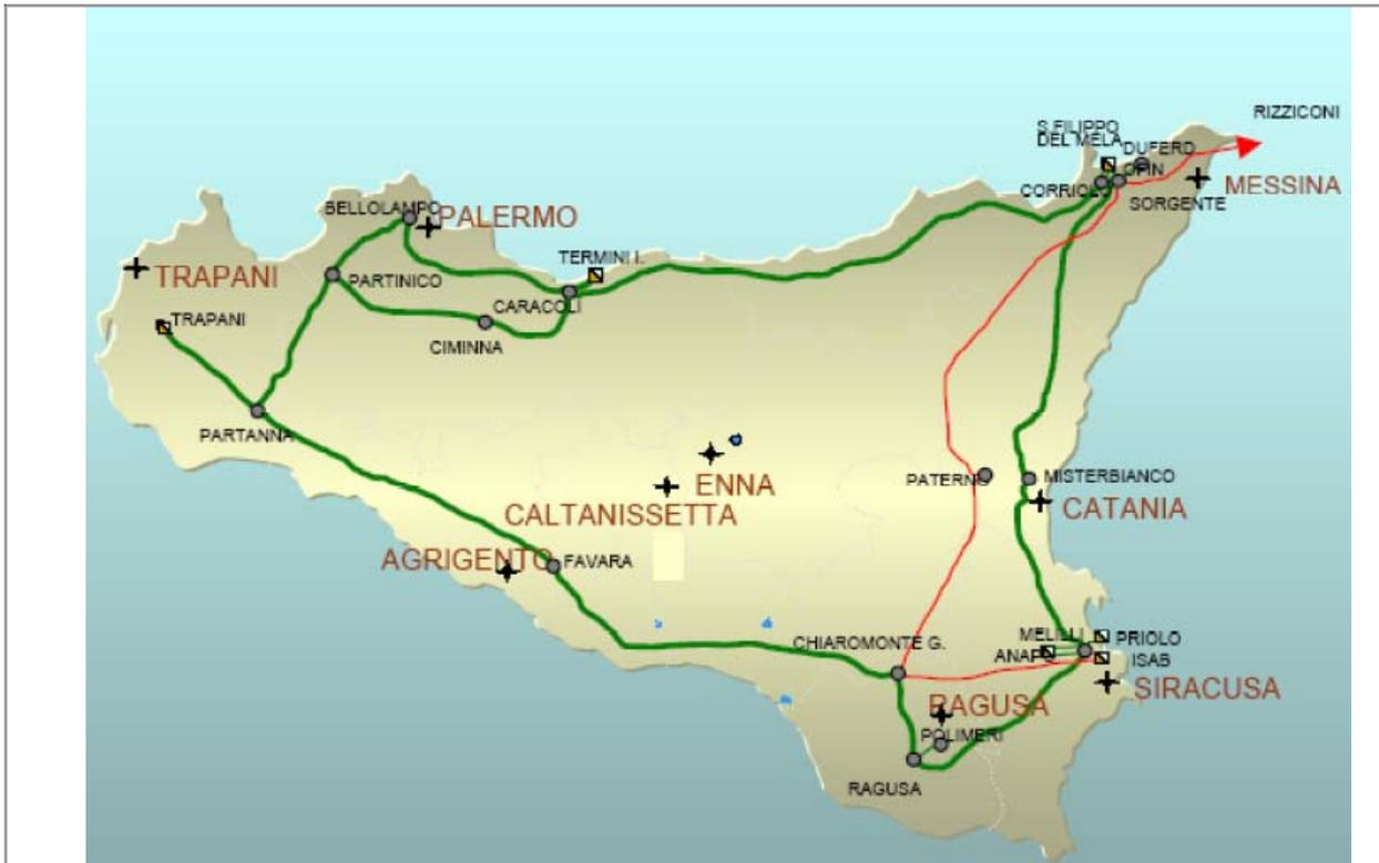
Fig. 7 - Rete di Trasmissione dell'energia elettrica in Sicilia (Fonte GRTN-TERNA)
