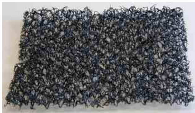
Esempio di struttura di geostuoia
