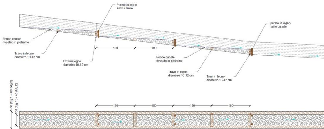
**Opere di dissipazione:** tali opere sono poste al termine degli scarichi, in modo tale da ridurre l'energia della corrente idrica reimpressa negli impluvi naturali e limitare quindi l'erosione dei versanti. Sono previste opere di dissipazione con pietrame di grandi dimensioni ( $D > 40$  cm), con differente geometria in funzione delle caratteristiche della corrente in uscita e del corpo idrico ricettore.
