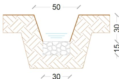
**Fossi di guardia in terra “Tipo B” per  $Q \geq 0,08$  m<sup>3</sup>/s e pendenza  $i \leq 6,00\%$** , aventi le seguenti caratteristiche geometriche:
