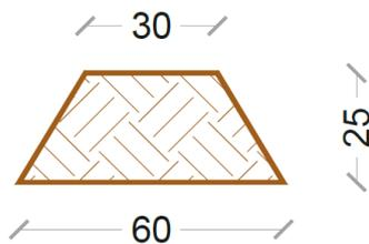
**Attraversamenti “Tipo T” in corrispondenza dei punti di scarico:** tale tipologia di attraversamento è necessaria per lo scarico - presso gli impluvi esistenti - delle acque meteoriche (di piattaforma e provenienti dai versanti) intercettate dai fossi di guardia.
