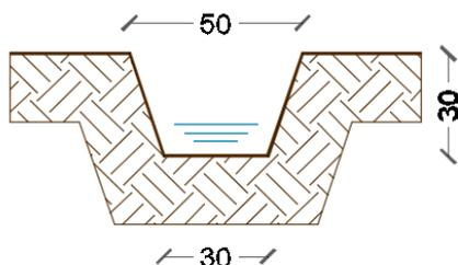
Nei tratti con pendenze comprese tra 6,00 e 11,00% tali fossi di guardia (**Tipo BP**) presentano il **fondo rivestito con pietrame** di media pezzatura ( $d=5-10$  cm), per uno spessore di 15 cm, al fine di ridurre l'azione erosiva della corrente idrica.
