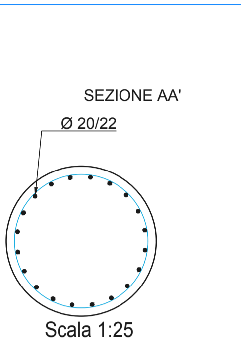
SEZIONE AA' Ø 20/22 Scala 1:25
