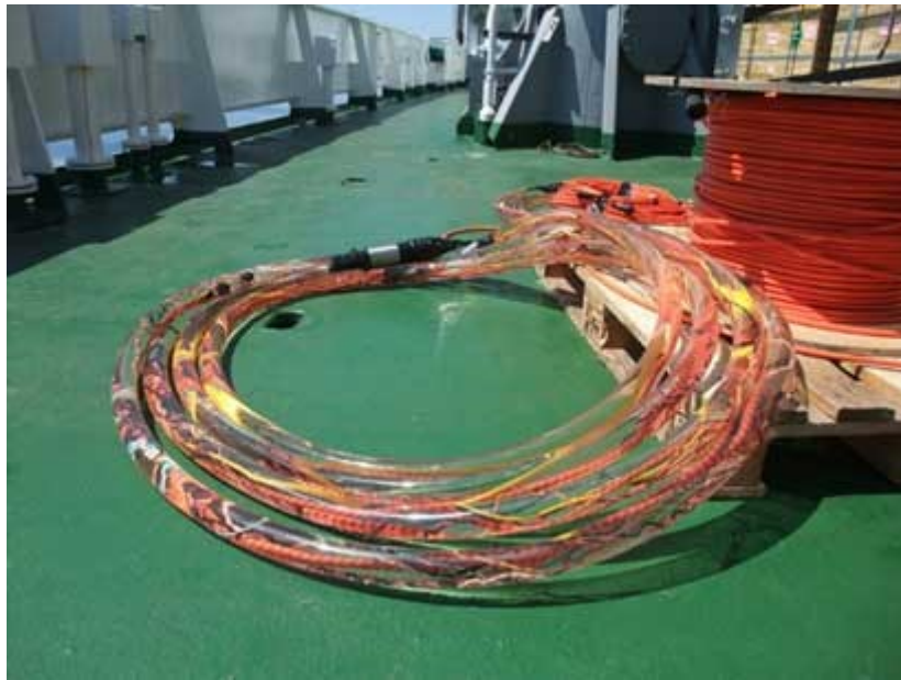
Fig. 11. Array acustico trainato (CIBRA) utilizzato nella fase ante operam
