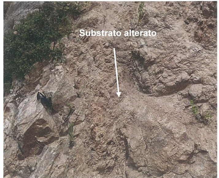
Foto 6.1 e 6.2 – Substrato cristallino metamorfico da intensamente a poco alterato presenti nell'area del viadotto Felicius dismesso.
