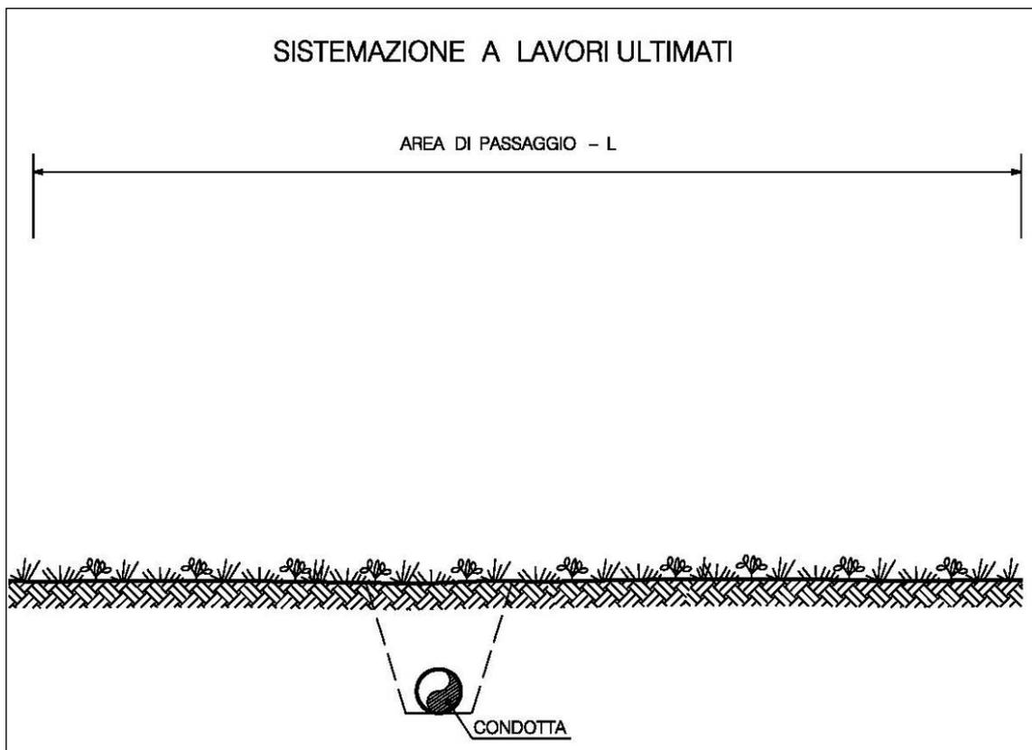
Per quanto concerne l'area e gli scavi funzionale alla posa dei nuovi metanodotti si precisa che il terreno il cui volume è occupato dalla nuova tubazione verrà riutilizzato sempre in situ, sia nel caso di posa in parallelismo con la condotta in rimozione che nel caso di posa su pista separata.
