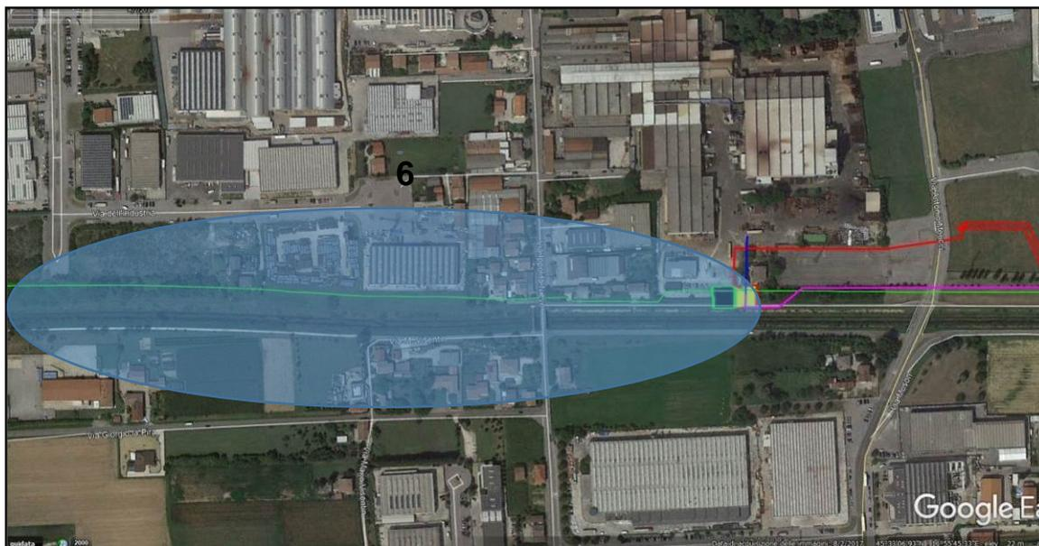
Immagine n.1.9 - Posa in parallelismo impedita dalla presenza di edifici in corrispondenza del parallelismo con il torrente Muson dei Sassi – in rosso il tracciato definitivo in magenta prima ipotesi di tracciato in blu met. esistente, in verde met. da sostituire
