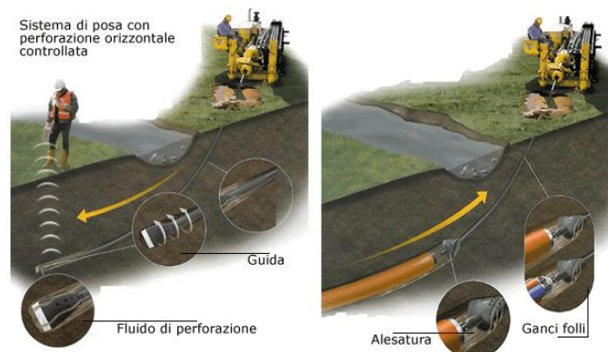
Fig. 1.3 – Posa in opera tubazione per alloggiamento cavi
