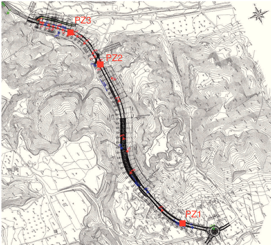
Figura 1 – Ubicazione pozzetti esplorativi con prelievo di campioni
