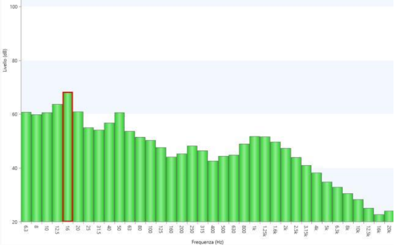
Figura 43 - Misura7: Spettro di frequenza in terzi d'ottave
