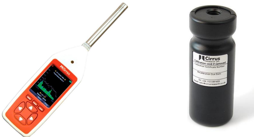
Figura 12 - Kit fonometro integratore
