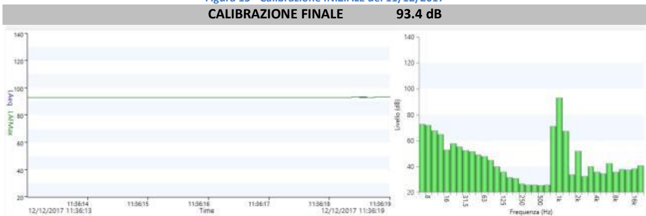
Figura 16 - Calibrazione FINALE del 11/12/2017
