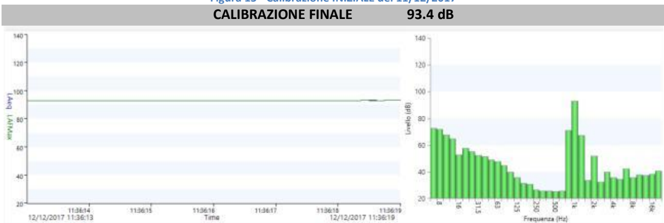
Figura 16 - Calibrazione FINALE del 11/12/2017
