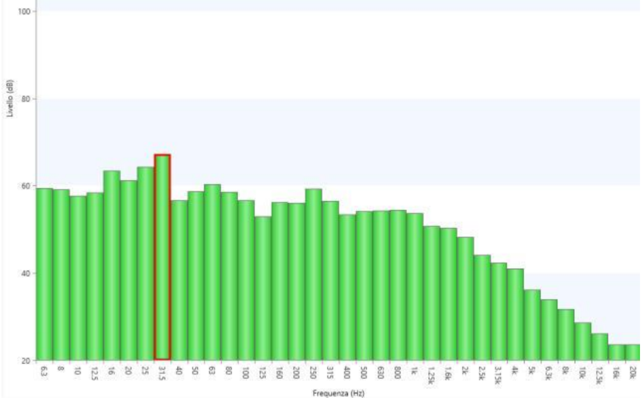
Figura 37 - Misura6: Spettro di frequenza in terzi d'ottave
