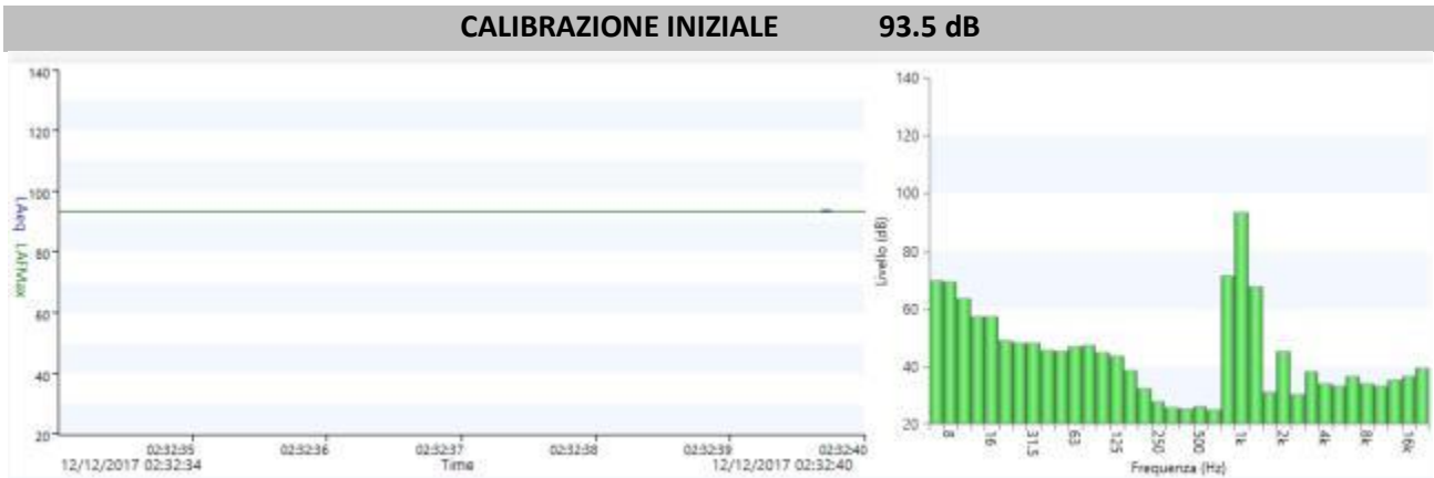
Figura 15 - Calibrazione INIZIALE del 11/12/2017
