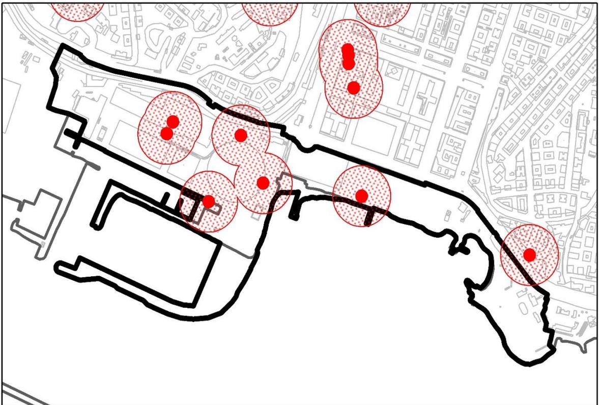
Antenne GSM e relativa area di rispetto di 80 metri
