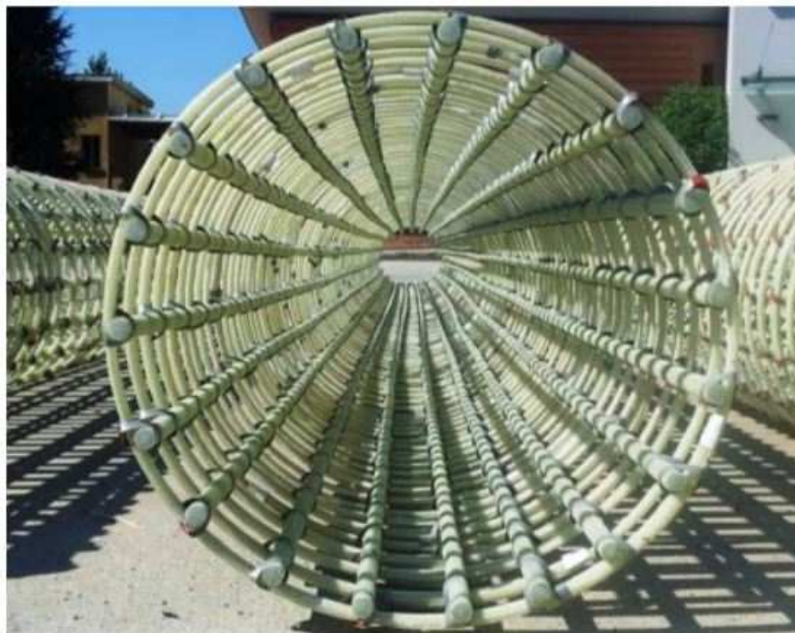
Immagine 15 – Sezione Gabbia in vetroresina per pali
