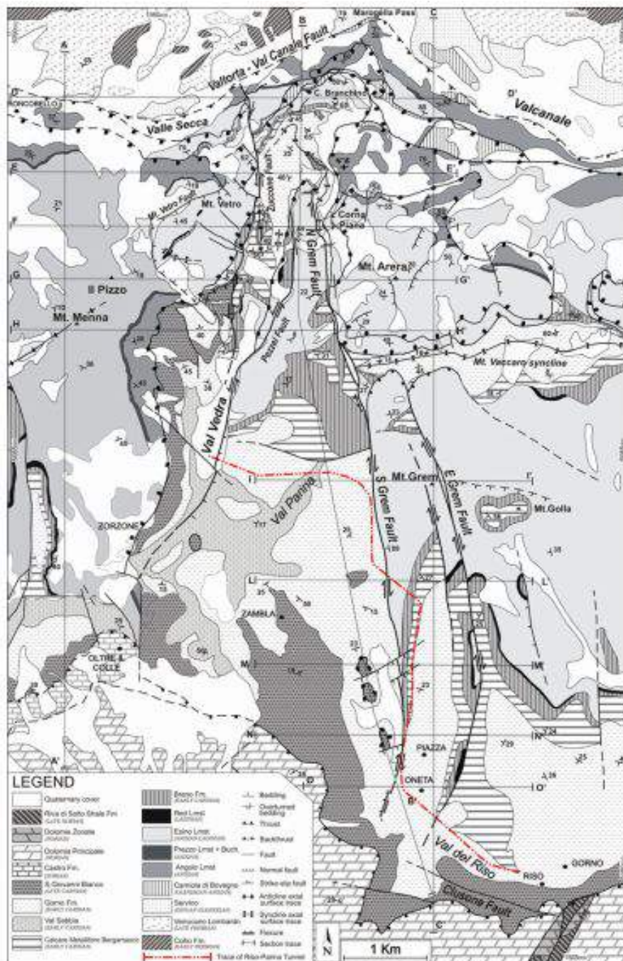
Schema geologico – strutturale traversale dell'area Grem-Vedra (Zanchi et Al., 2012).
