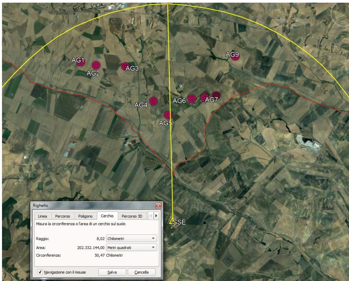
Figura 27 - Distanza tra la SSE e le turbine. In giallo un cerchio di raggio 8 km
