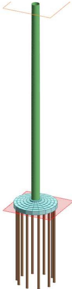
FIGURA 6: MODELLO SOLIDO DEL COMPLESSO TORRE IN ACCIAIO / BLOCCO DI FONDAZIONE
