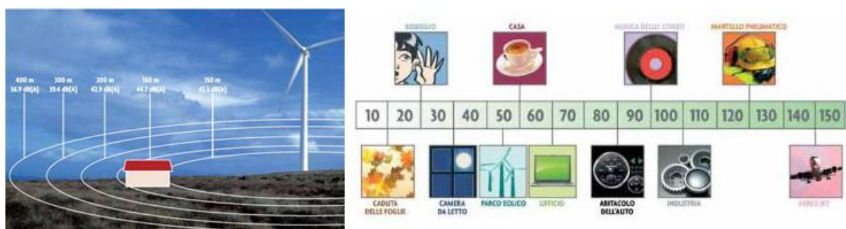
Figura 122: Misurazione del rumore provocato da un generatore eolico a diverse distanze e paragone con altre fonti di disturbo
