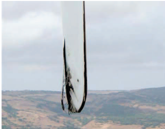
Estremità di pala danneggiata da fulminazione atmosferica.
