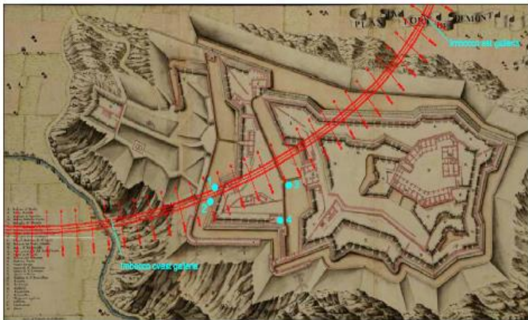
Immagine 30 Pianta storica del Forte della Consolata con la sovrapposizione del progetto e con i punti registrati durante la ricognizione con il GPS.
