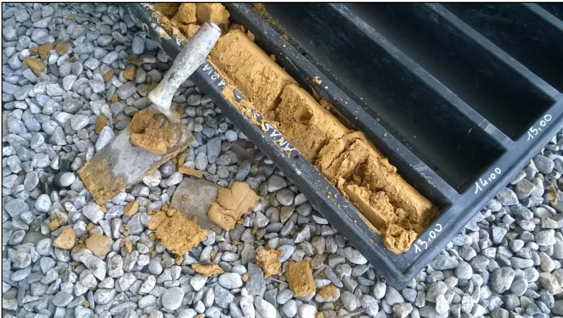
Figura 27 – elevata alterazione delle metarenarie - sondaggio orizzontale imbocca Ovest
