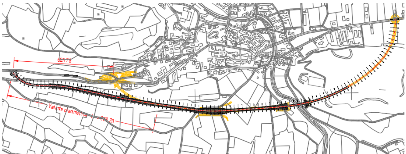
Figura 5 – Rappresentazione schematica dello spostamento verso monte del fine intervento della Alternativa 5 rispetto alla Alternativa 4
