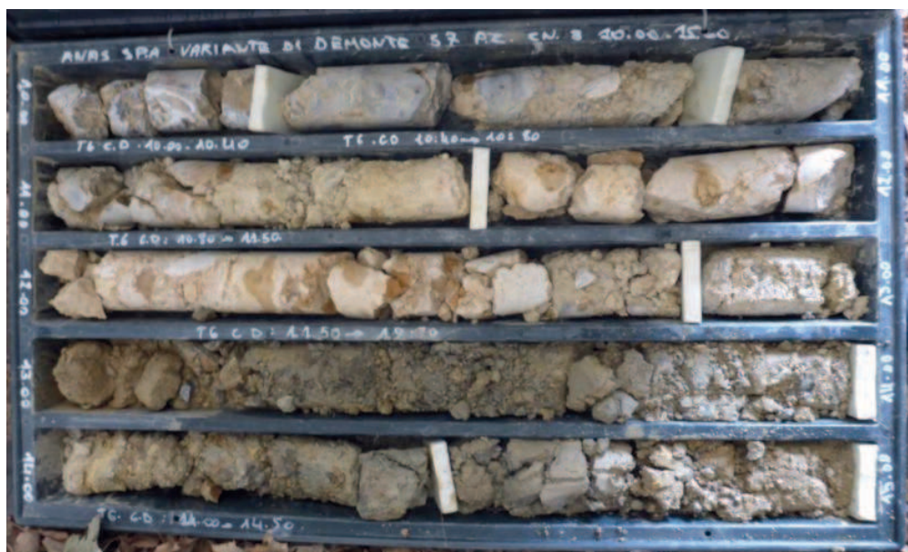
Figura 19: Meta calcari intensamente tettonizzati campionati dal sondaggio S7-P tra le progressive 10-15m ed attribuiti all'unità geomeccanica UGm_i.
