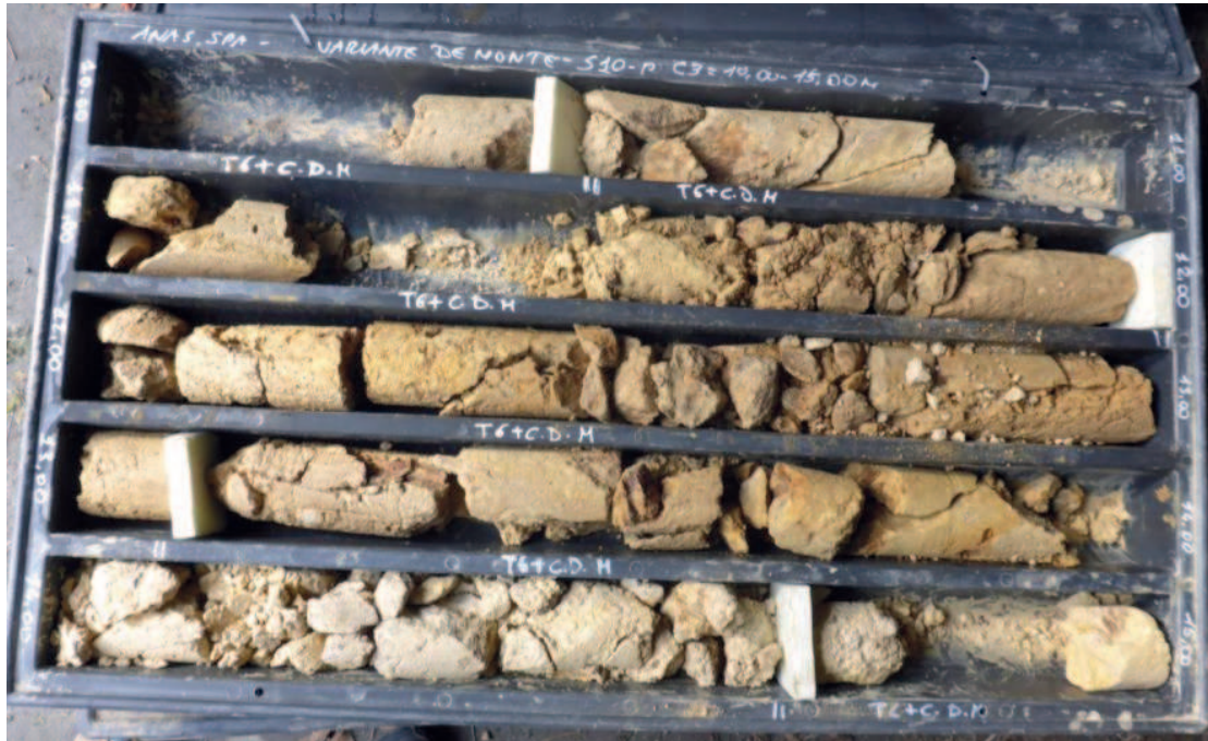
Figura 16: Depositi triassici associati all'unità geotecnica UGm4 perforati tra 10-15m nel sondaggio S10-P.
