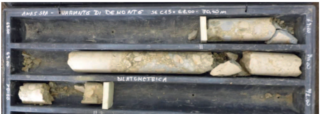
Figura 16: Depositi triassici associati all'unità geotecnica UGm4 perforati tra 10-15m nel sondaggio S10-P.
