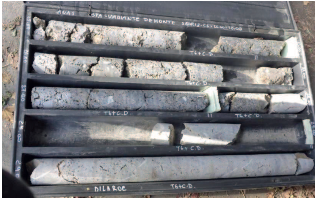
Figura 13: Tratta di sondaggio S8_orizz compresa tra le progressive 25-30m e caratterizzata dalla presenza di meta calcari inseriti entro l'unità UGm1.
