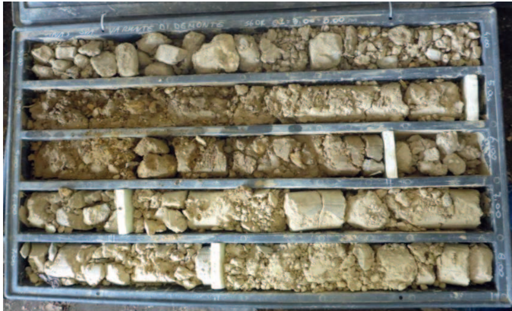
Figura 18: Meta calcari intensamente tettonizzati campionati dal sondaggio S6_orizz tra le progressive 3-8m ed attribuiti all'unità geomeccanica UGm_i.
