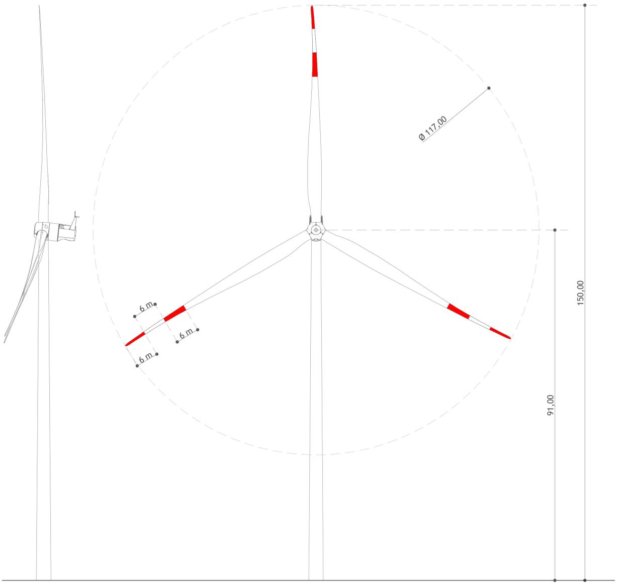
Potenza aerogeneratore: 2,4 MW
