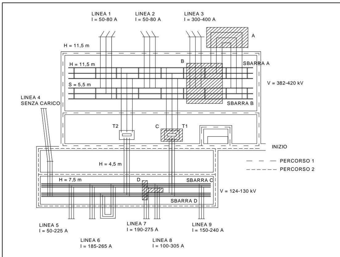
Figure 1: Pianta di una tipica stazione 380/132 kV con l'indicazione delle principali distanze fase-fase (S) e fase-terra (H) e delle variazioni delle tensioni e delle correnti durante la fasi di misurazioni di campo elettrico e magnetico
