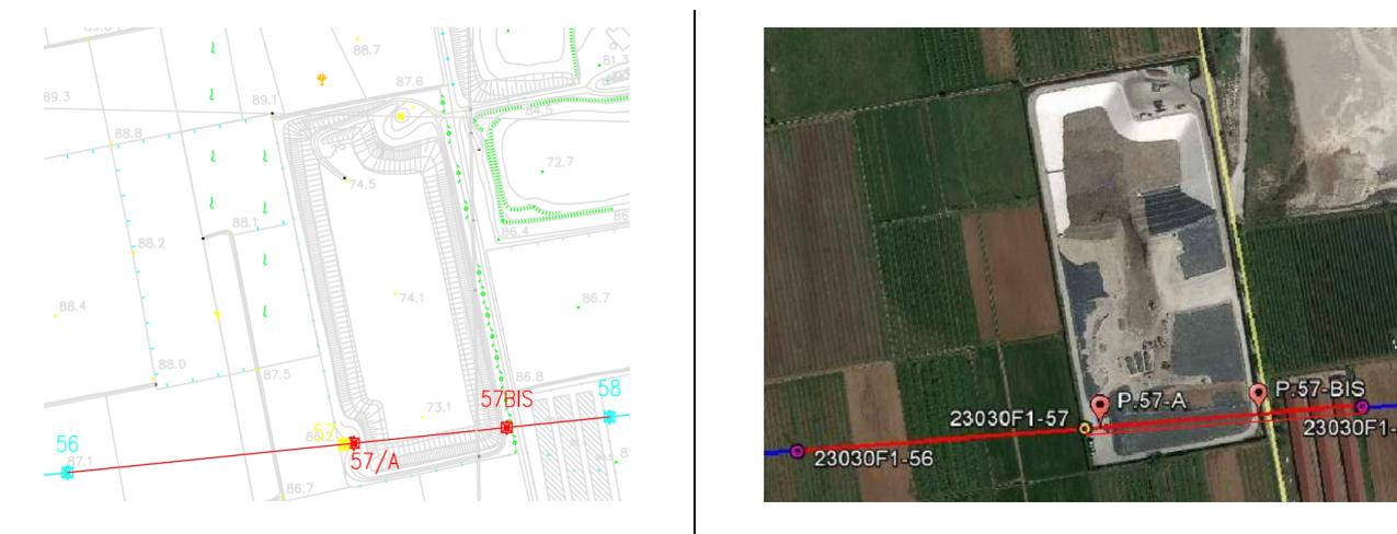
Fig. 1: In rosso - linee e sostegni in progetto. In celeste - linee e sostegni esistenti. In giallo - sostegni da smantellare.
