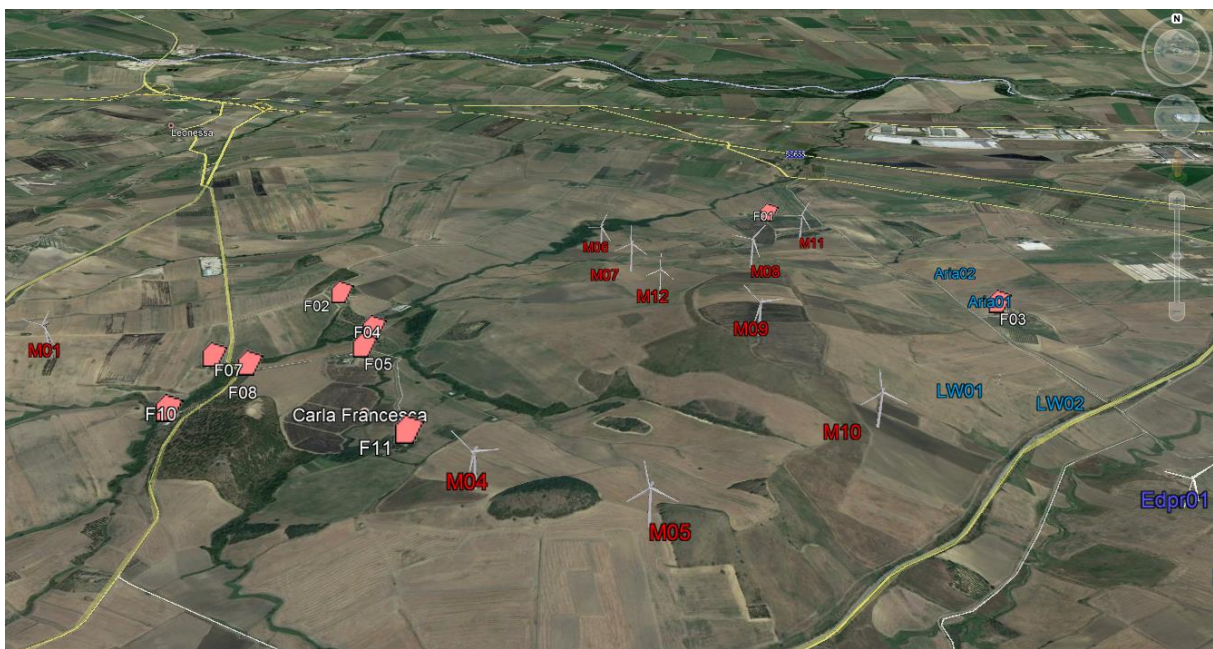
Figura 11: Zona d'impianto con individuazione dei recettori sensibili (Poligoni rosa) e con evidenza delle turbine di progetto (etichette in rosso) ed esistenti considerate nel modello di simulazione (etichette in blu) proposto su stralcio di ortofoto estratta da Google Earth proposta in versione 2D e 3D.
