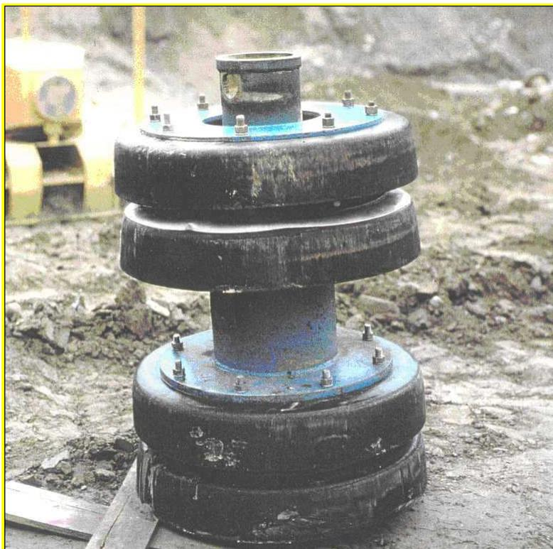
**Fig. 9.1 - Pig convenzionale impiegato nelle operazioni di collaudo idraulico e di pulizia della condotta.**
