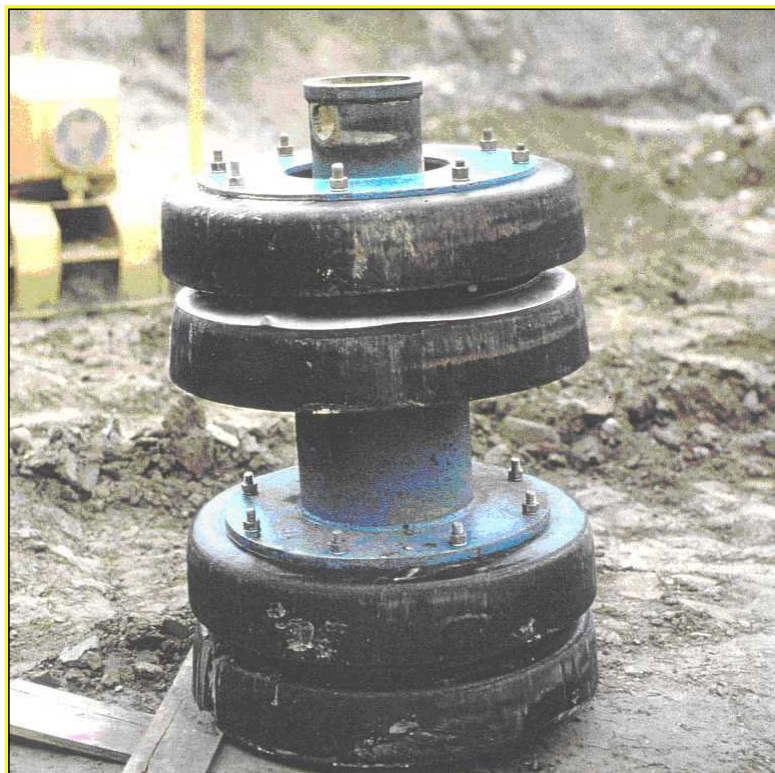
Fig. 2.15 - Pig convenzionale impiegato nelle operazioni di collaudo idraulico e di pulizia della condotta.
