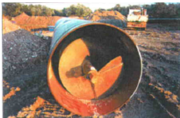
Fig. 2.9 - Coclea per trivella spingitubo.
