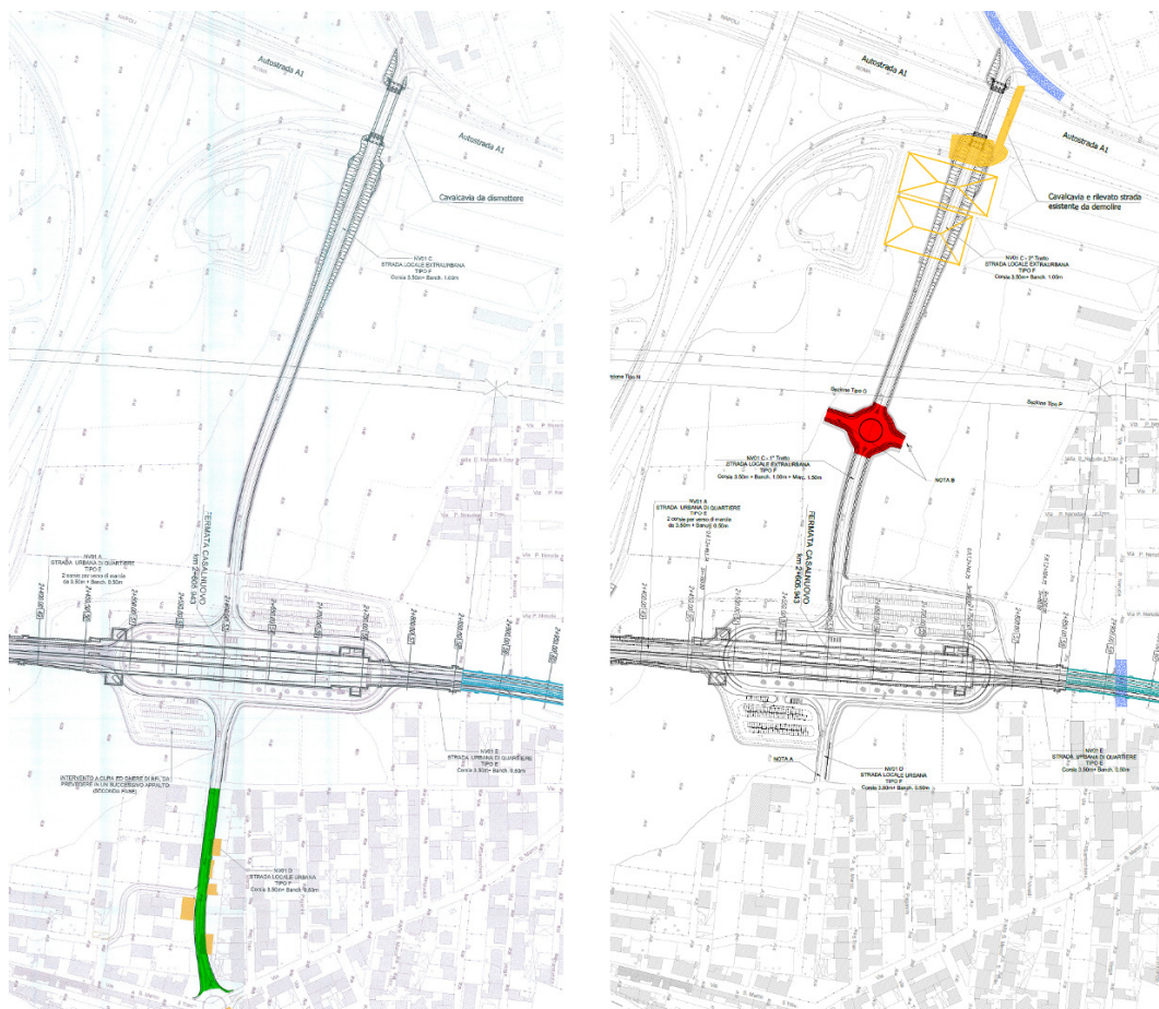
Figura 10 – Contesto di analisi B – Confronto tra la configurazione del Progetto Definitivo (a sinistra) e quella del Progetto Esecutivo (a destra) - in rosso la rotatoria introdotta; in verde il tratto di viabilità stralcio.
