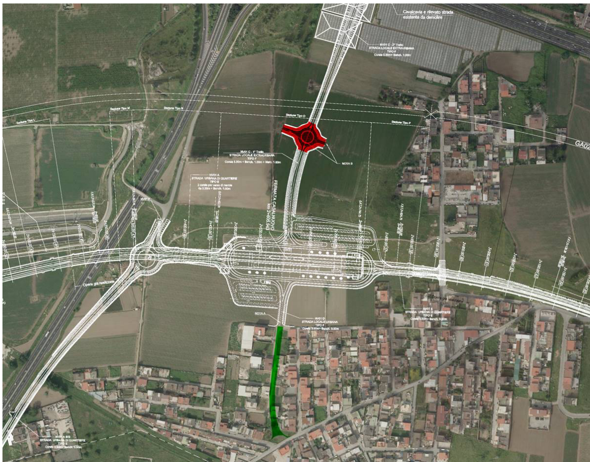
Figura 11 – Inquadramento su foto aerea dell'ambito di progetto interessato dalla modifica (in rosso la nuova rotatoria, in verde il tratto di viabilità stralciata dal progetto)
